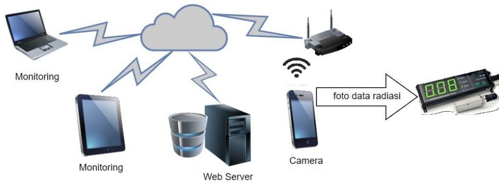
Gambar 3. Arsitektur sistem pembacaan dan perekaman data radiasi berbasis IoT dan OCR pada *IT-09 Data Panel*
